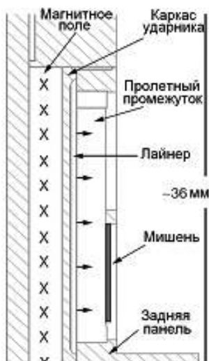
Рис. 1.41. Схема ускорения лайнера магнитным давлением, генерируемым током плотностью J от Z-ускорителя, направленного вверх в слое, расположенном далеко слева, который генерирует магнитное поле B в плоскости рисунка. Каркас лайнера является анодом Z-ускорителя, с которым лайнер (ударник) находится в контакте, и ускоряется в правую сторону. Ширина пролетного промежутка 3–4 мм
