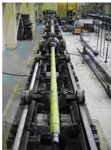
Рис. 1.3. Пороховая пушка РФЯЦ-ВНИИЭФ на рельсовых направляющих
