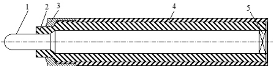
Рис. 2.1. Коаксиальный электроконтактный датчик [3]: 1 — латунный стержень; 2 — электроизоляция; 3 — наконечник; 4 — корпус датчика; 5 — слюдяная шайба
