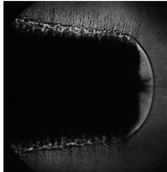
Рис. 12.7. Фрагмент полученного камерой с электронно-оптическим затвором теневого изображения в проходящем свете торца удлиненного заряда в оболочке при взрыве в воздухе
