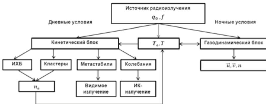
Рисунок 7.1. Схема решения пространственно-временной задачи с учетом взаимосвязи кинетической и динамической части. Здесь ИХБ – атомы, ионы и молекулы, участвующие в ионизационно-химических процессах
