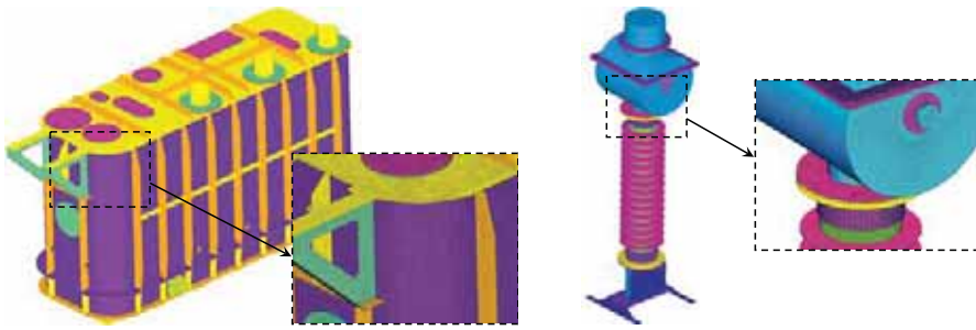
Рис. 7.20. Конечно-элементные модели трансформаторов: а) трансформатор мощности; б) трансформатор тока
