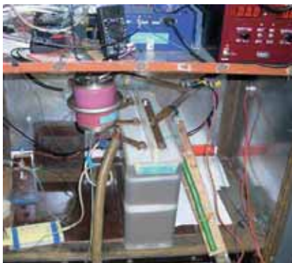
Рис. 9.35. Установка для взрыва проволоочки импульсом электрического тока: 1 – разрядник РГУ-1, 2 – высоковольтный конденсатор 54 мкФ 15 кВ, 3 – высоковольтный источник питания ИВН-3
