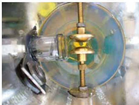
Рис.2.3. Электроды в разрядной камере
