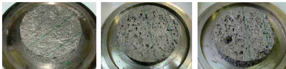
Рис. 9.42. Образцы винипласта после воздействия ударной волны
