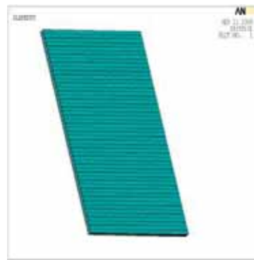
Рис. 9.50. Стенка со слоем пеноалюминия (размеры 1 \text{ м} \times 1 \text{ м} )
