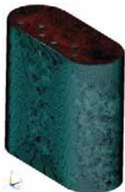
Рис. 9.81 а) Набор элементов для задания давления: а) корпус; б) вставки из пеноалюминия.
