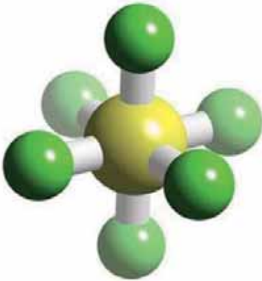
Рис. 10.24. Структура молекулы и свойства элегаза SF 6
