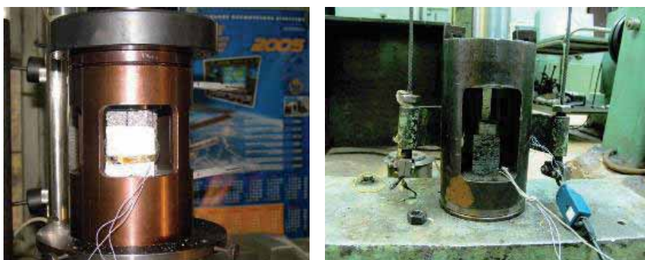
Рис. 9.19. Общий вид приспособления для испытаний образцов на а) статическое и б) динамическое сжатия
