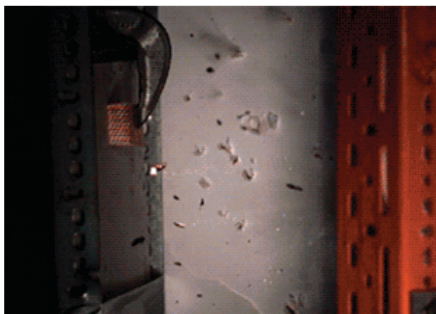
Рис. 9.10. Состояние пенометалла после попадания осколков и ударной волны на поверхность [36]
