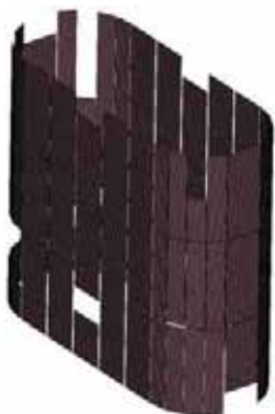
Рис. 9.81 а) Набор элементов для задания давления: а) корпус; б) вставки из пеноалюминия.
