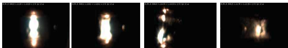
Рис. 2.10. Кадры при скоростной визуализации процесса пробоя трансформаторного масла
