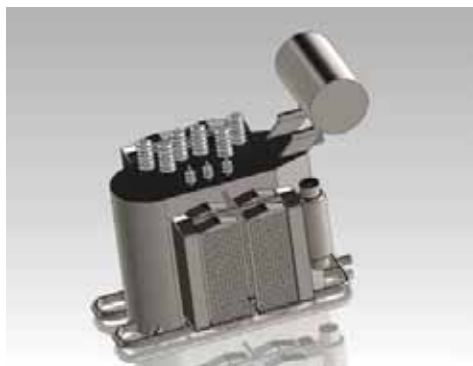
Рис. 6.29. Общий вид модели маслонаполненного автотрансформатора с динамической защитой
