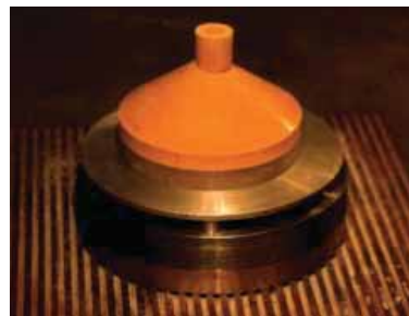
Рис. 5.7а. Взрывное метательное устройство: 1 – взрывная линза, А-IX-1/парафин, D = 100 ; 2 – диск Д16Т, D = 150 , h = 4 ; 3 – столбики, фиксирующие подлетную базу D = 20 , h = 8 ; 4 – мишень. Метается центральная часть алюминиевого диска, вырывающаяся взрывом. Скорость метания 1.46 км/с. Справа – фотография экспериментальной сборки
