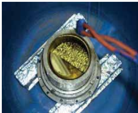
Рис. 9.36. Внутренний вид взрывной камеры. 1 – датчик давления РСВ 109С11, установленный на дне камеры, 2 – демпфирующий пористый материал, закрывает второй датчик давления РСВ 109С11, расположенный центрально – симметрично первому на внутреннем диаметре дна камеры
