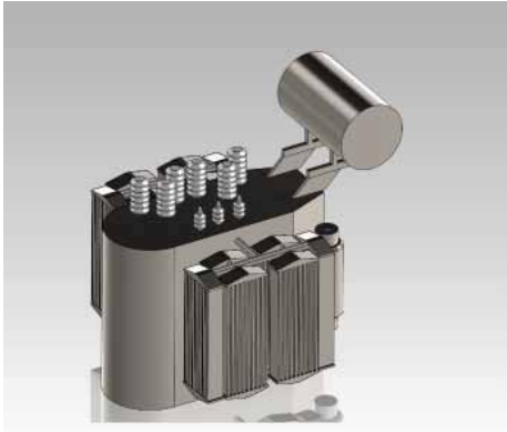
Рис. 6.25. Общий вид модели маслонаполненного автотрансформатора
