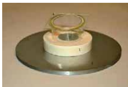
Рис. 5.14б Часть экспериментальной сборки с образцом. 1 – образец, D = 55.5 мм, h = 15 мм; 2 – алюминиевая фольга 200 мкм; 3 – алюминиевый экран диаметром 120 мм и толщиной 4 мм; 4 – кювета для воды
