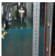
Рис. 2.5. Уровень чистого и газированного трансформаторного масла
