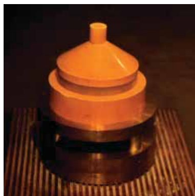
Рис. 5.8а. Взрывное метательное устройство: 1 – взрывная линза, А-IX-1/парафин, D = 100 ; 2 – ВВ А-IX-1, D = 120 , h = 30 ; 3 – фокусирующее кольцо, сталь, D_{\text{ext}} = 150 , h = 16 ; 4 – ударник, Д16Т, D = 90 , h = 10 ; 5 – столбики, фиксирующие подлетную базу, D = 20 , h = 25 ; 6 – мишень. Скорость метания 2.5 км/с. Справа – фотография экспериментальной сборки
