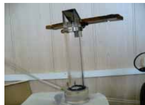
Рис. 2.9. Стеклянный тубус, для спектральных измерений
