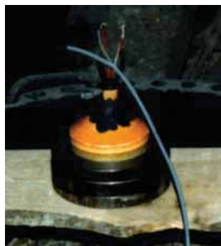
Рис. 5.6а. Взрывное метательное устройство: 1 – взрывная линза, А-IX-1/парафин, D = 100 ; 2 – фокусирующее кольцо, сталь, D_{\text{ext}} = 150 , h = 16 ; 3 – ударник, Д16Т, D = 90 , h = 7 ; 4 – мишень. Скорость метания 1.13 км/с. Справа – фотография экспериментальной сборки
