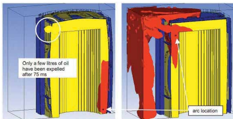
а) пробой на другой стороне от клапана б) пробой рядом с клапаном
