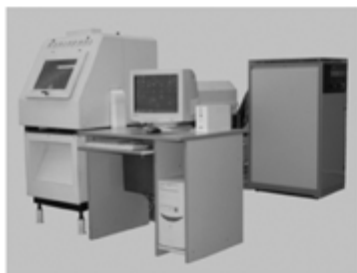
Рис. 12. Промышленные АЛТУ «Каравелла-1» и «Каравелла-1М» на базе двухканальных ЛСПМ «Кулон-10» и «Кулон-20» для прецизионной микрообработки тонколистовых материалов ИЭТ толщиной 0,2-0,5 мм и 0,6-1 мм.
