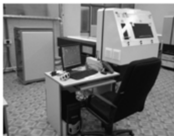
Рис. 12. Промышленные АЛТУ «Каравелла-1» и «Каравелла-1М» на базе двухканальных ЛСПМ «Кулон-10» и «Кулон-20» для прецизионной микрообработки тонколистовых материалов ИЭТ толщиной 0,2-0,5 мм и 0,6-1 мм.
