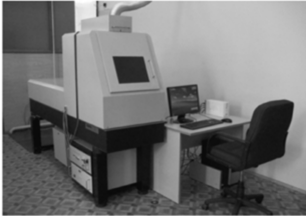
Рис. 13. Промышленные АЛТУ «Каравелла-2» и «Каравелла-2М» на базе одноканального ЛПМ «Кулон-06» для прецизионной микрообработки фольговых материалов ИЭТ толщиной 0,01-0,2 мм.
