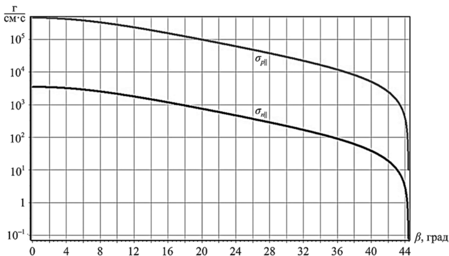
Рис. 7.2. Проекции плотности потока импульса плазмы \sigma_{p||} и нейтронов \sigma_{n||} , созданные продуктами ядерного взрыва, на поверхность астероида в зависимости от угла \beta
