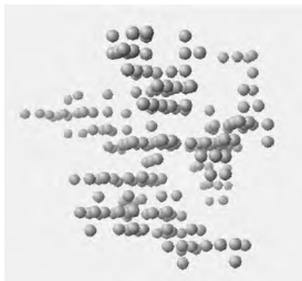
Рис. 8.11. Геометрия кластера в решетке типа алмаз, получающегося при моделировании методом МК.
