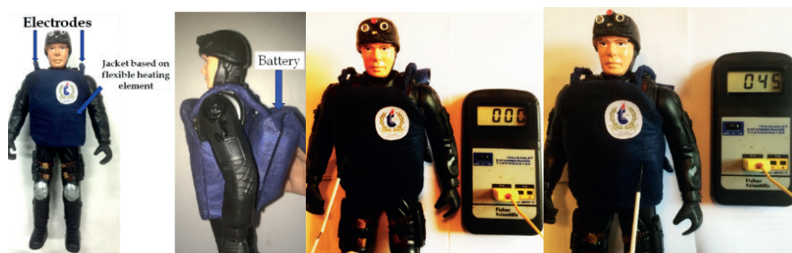
Рис. 15. Фотографии макета и динамика изменения температуры жилета до подключения и после подключения жилета к источнику питания.
