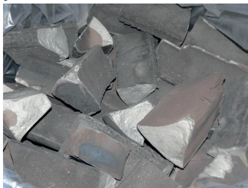
Рис. 5. Промышленные образцы плавленного нитрида феррованадия.
