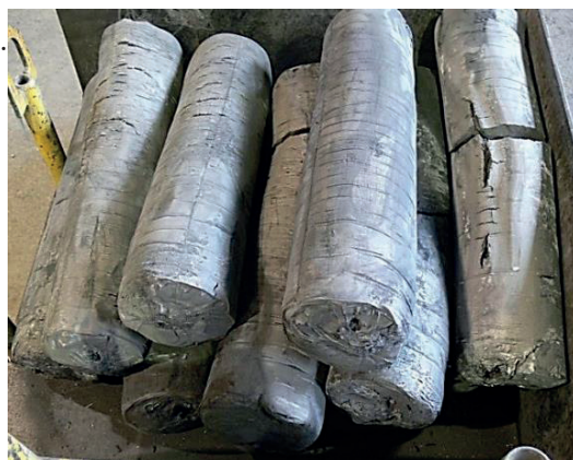
Рис. 9. Промышленные образцы спеченного нитрида феррохрома.
