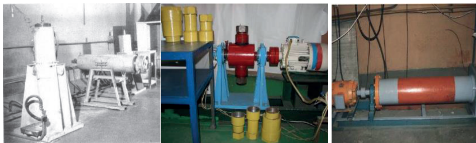
Рис.1. Реакторы и центробежные установки для реализации СВС-металлургии.
