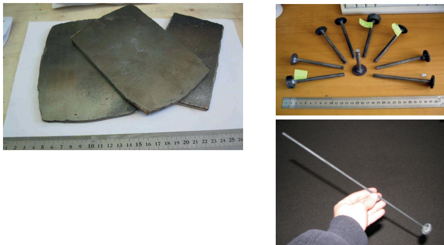
а) б) Рис. 12. Фото образцов: а - плиты, полученные методом свободного СВС-сжатия, б – электроды, полученные методом СВС-экструзии.
