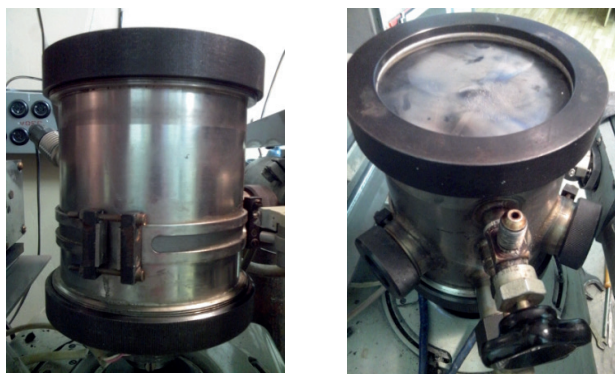
Рис. 1. Внешний камеры для организации синтеза материала.
