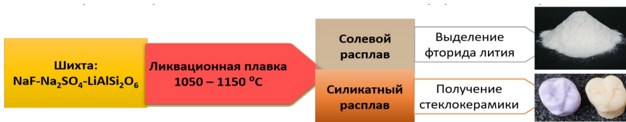
Рис. 78. Технология одностадийного синтеза фторида лития из сподумена – минерального сырья
