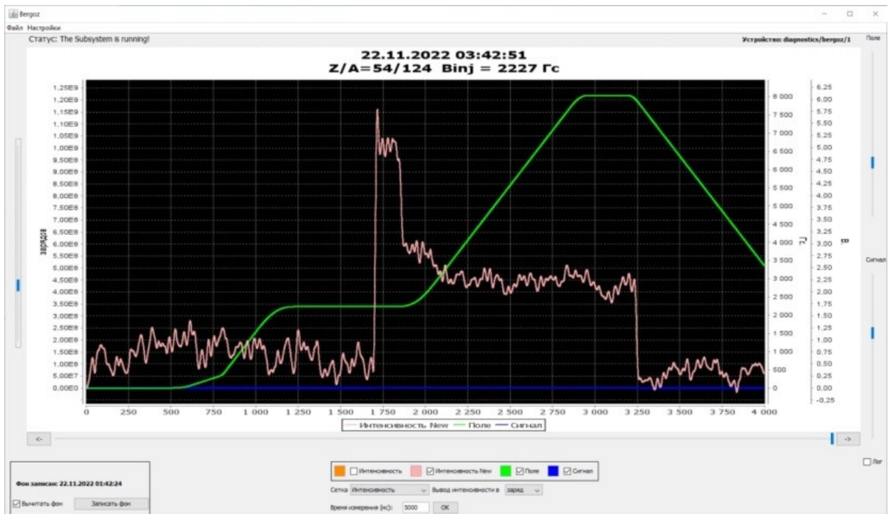
Рис. 36. Цикл магнитного поля нуклотрона и интенсивность пучка ядер ксенона, измеренная параметрическим трансформатором тока, в процессе настройки для эксперимента VM@N.
