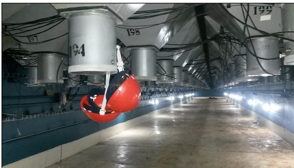
Рис. 34 Мюонный детектор установки «Ковер-2», позволяющий выделять редкие ливни от фотонов на фоне большого количества событий от космических лучей.
