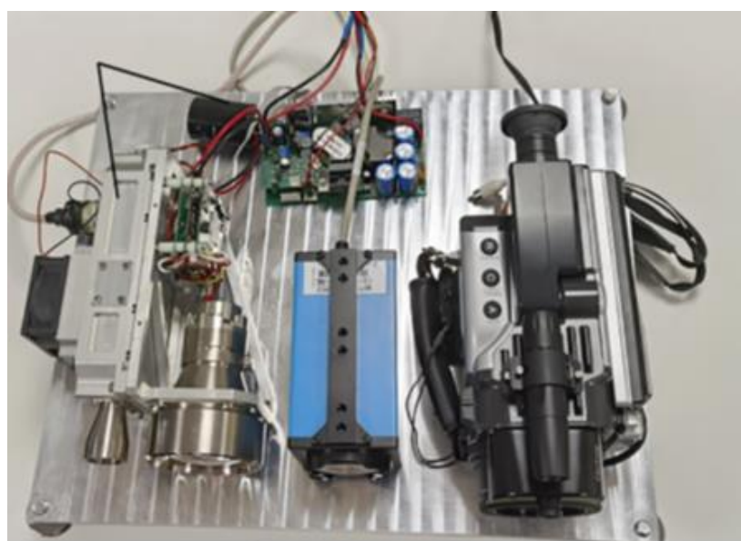
Рис. 35. Система оптической локализации беспилотных летательных аппаратов в видимом и инфракрасном диапазонах
