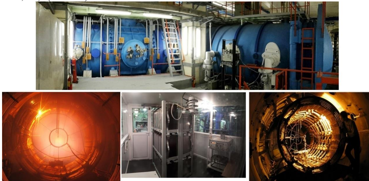
Рис. 110. Плазменная камера стенда «Крот»: вакуумный объем: 180 \text{ м}^3 предельный вакуум: 10^{-6} Торр, объем плазмы: до 80 \text{ м}^3 , рабочий газ: Ar, Ne, He, \text{H}_2 , концентрация плазмы: 10^{13} \text{ см}^{-3} , магнитное поле: до 1 кГс
