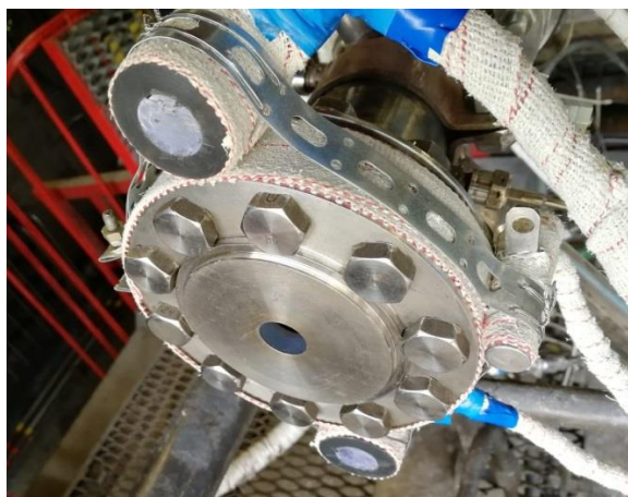
Рис. 32. Датчики магнитного поля на сопле модельного газогенератора
