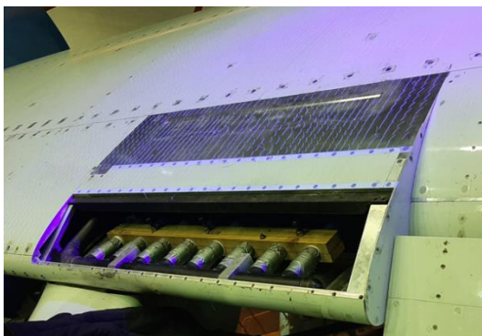
Рис. 72. Крупномасштабная модель отсека крыла
