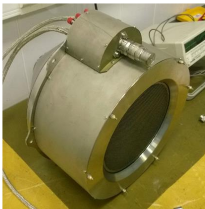
Рис. 97. Внешний вид ионного двигателя ИД-200КР мощностью от 2 до 3 кВт со скоростью истечения не менее 45 км/с
