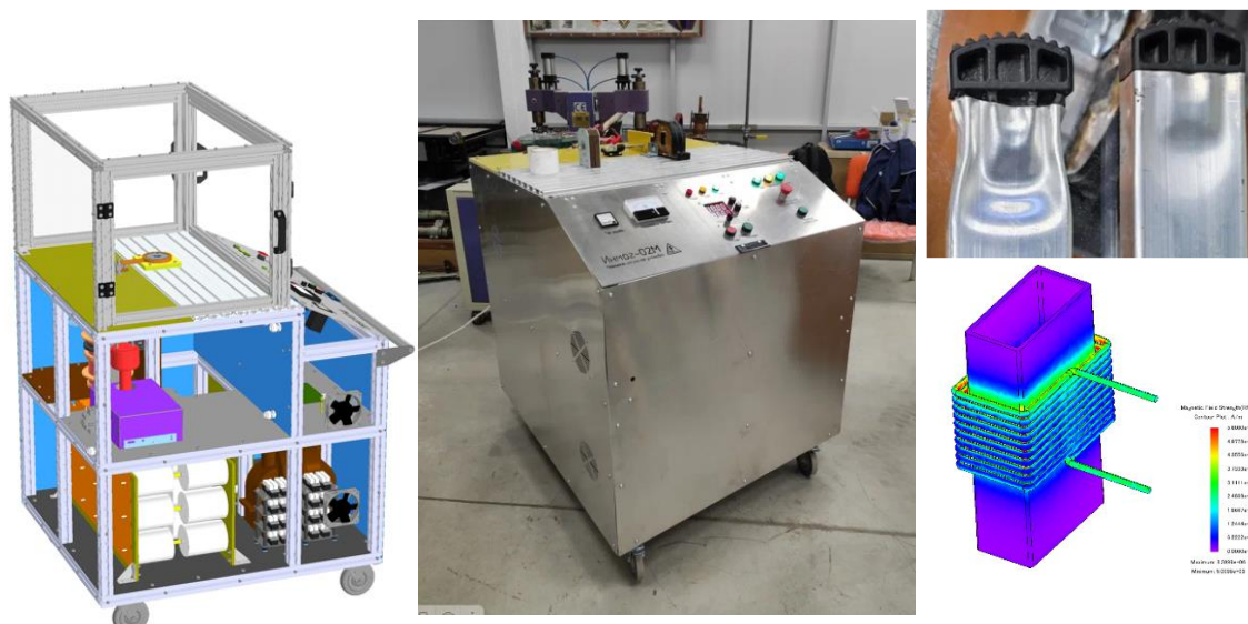
Рис. 59. 3D модель и макет магнитно-импульсной установки для сборочных операций
