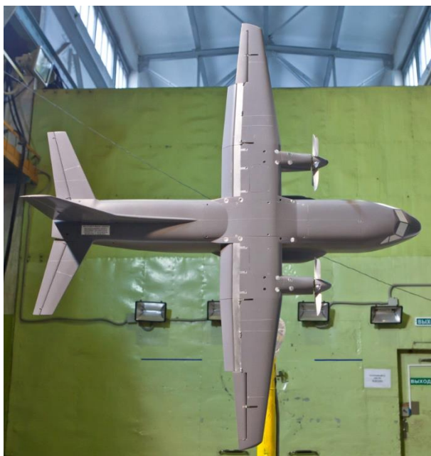
Рис. 70. Фотография модели двухдвигательного самолета с работающими воздушными винтами в аэродинамической трубе
