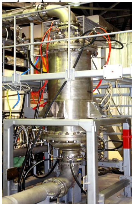
Рис. 96. Тепловой имитатор реакторной установки
