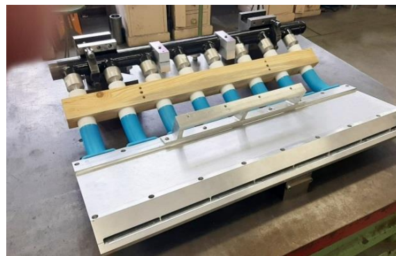
Рис. 73. Изготовленный демонстратор из восьми эжекторов
