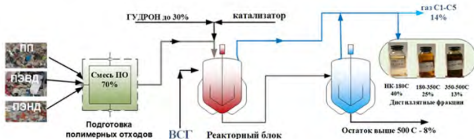
Рис. 28. Структурная схема гидроконверсии отходов полиолефинов в смеси с гудроном
