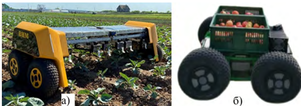
Рис. 57. Комплекс мобильных роботизированных средств для возделывания овощных культур, а) – роботизированное средство для химической защиты растений, дифференцированного внесения удобрений и удаления сорной растительности, б) – универсальная роботизированная платформа
