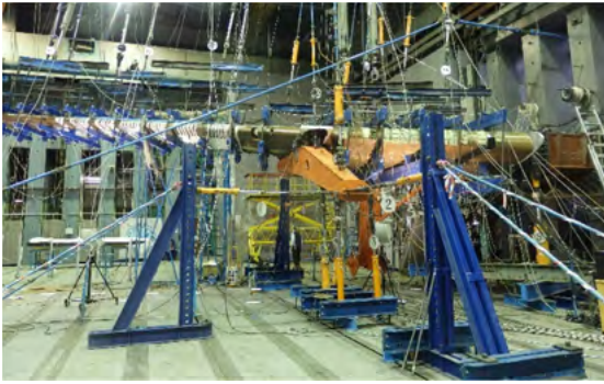
Рис. 73. Испытания крыла из ПКМ с нагревом
