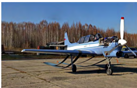
Рис. 108. Подготовка к измерению статической тяги СУ
