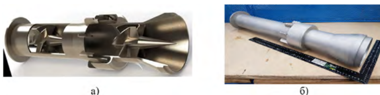
Рис. 92. 3D модель (а) и сепарационный модуль изготовленный с применением аддитивных технологий (б)
