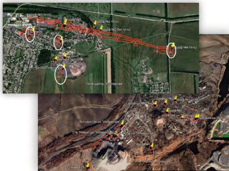
Рис. 121. Поля шахт «Ростовская» и «Иловайская» с зонами провалообразования
