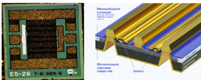
Рис. 30. Фотография и схематичное изображение высокочастотного нитридгаллиевого транзистора с тонким AlN барьером на кремниевой подложке
