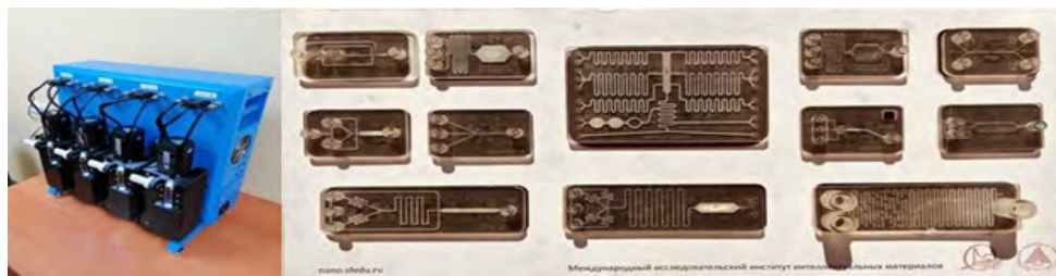
Рис. 10. Разработанная в ЮФУ самоуправляемая система для ускоренной разработки материалов и набор специализированных микрофлюидных чипов
