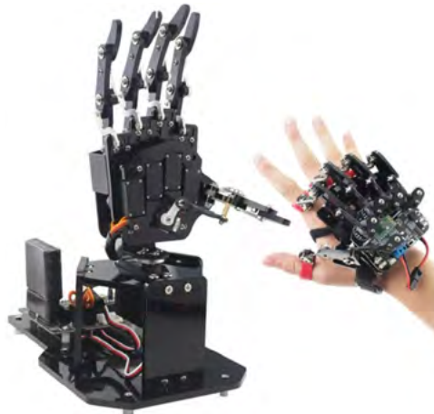
Рис. 117. Дистанционное управление роботизированной рукой при помощи механической перчатки
