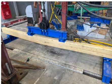
Рис. 31. Испытание образца из клееной древесины на циклическое воздействие
