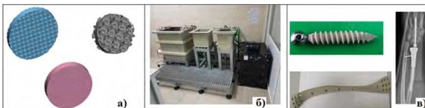
**Рис. 144.** а) - Варианты физической модификации поверхности импланта; б) - Нанесение покрытия. Линия микродугового оксидирования; в) Компоненты изделий с кальций-фосфатным покрытием
