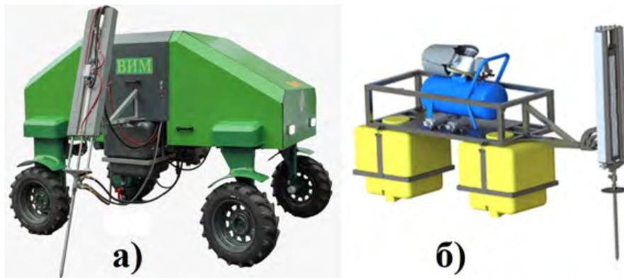
**Рис. 185.** Роботизированная мобильная платформа с гидропневматическим инъектором для внесения питательных веществ в корневую зону многолетних культур (а) и роботизированный гидропневматический инъектор для внесения питательных веществ в корневую зону многолетних культур (б)
