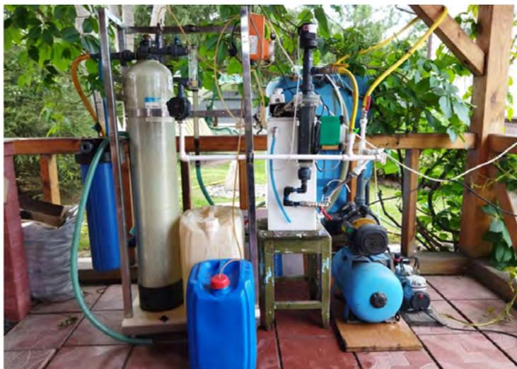
**Рис. 208.** Экспериментальная установка станции водоочистки села Верх-Тула
