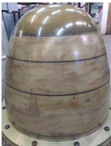
**Рис. 71.** Конструктивно-подобный макет обтекателя ГАА
