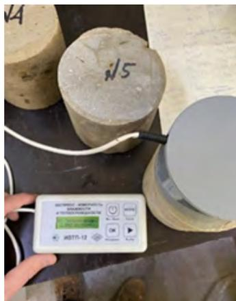
Рис. 206. Определение теплопроводности грунтоцемента
