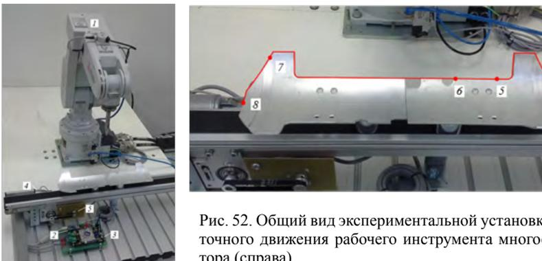
Рис. 52. Общий вид экспериментальной установки (слева) и траектория точного движения рабочего инструмента многостепенного манипулятора (справа)
