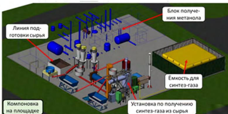
**Рис. 59.** Компановка на площадке и технологической цепочка ректификации водно-метанольной смеси для получения продукта товарной чистоты
