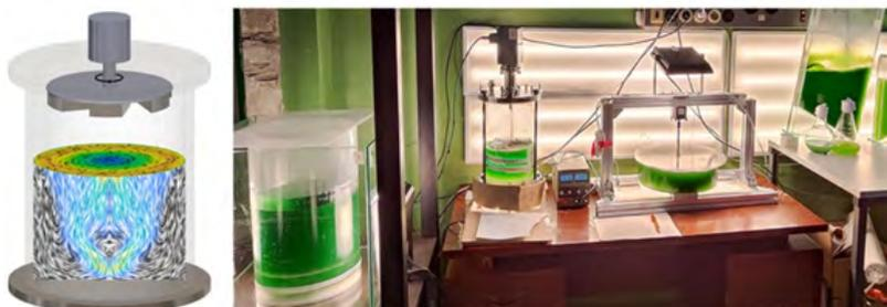
**Рис. 55.** Пример структуры течения культуральной среды в газовихревом биореакторе (слева), сравнительные конфигурации вихревых реакторов (справа).
