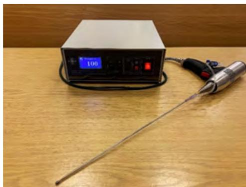
**Рис. 136.** Макет аппарата для эндовенозного ультразвукового лечения варикозной болезни нижних конечностей
