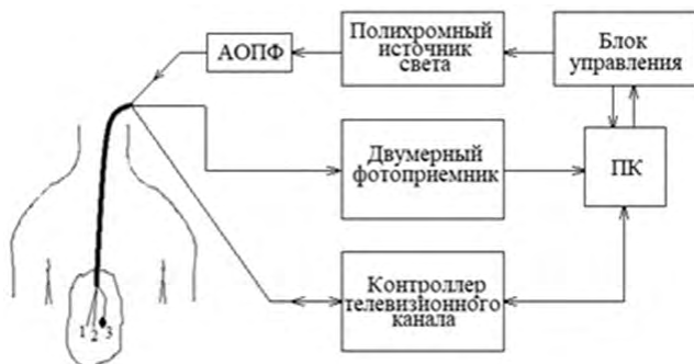
Рис. 34.2. Структурная схема макета гибридного эндоскопа для диагностики рака внутренних органов на основе многоспектрального анализа (АОПФ – акустооптический перестраиваемый фильтр; 1 – оптоволоконный облучатель; 2 – оптоволоконный датчик изображений; 3 – TV-камера)
