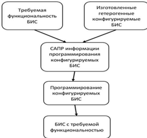
Рис. 37. Алгоритм программирования БИС с требуемой функциональностью
