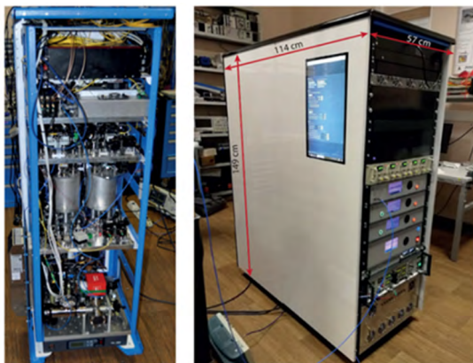
Рис. 15. Транспортируемые оптические часы на одиночном ионе иттербия
