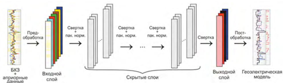
Рис. 91.1. Архитектура искусственной нейронной сети для экспресс-инверсии сигналов электротометрии в геоэлектрические модели
