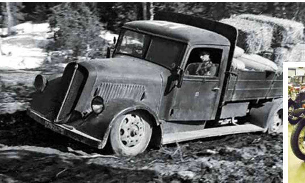
◀ Гражданский 3-тонный грузовик «Австро-ФИАТ» образца 1937–1938 годов с двигателем мощностью 65 л. с. в Вермахте. Территория оккупированной Прибалтики, 1942 год.
