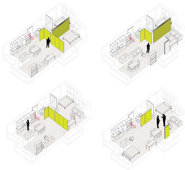
Figura 4. Esquema espacio flexible en función de las necesidades del usuario; Fuente: <http://www.openarch.cc>
