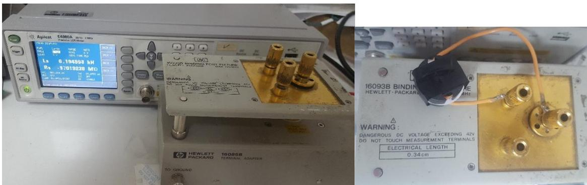
Figura 5.25 Aparato de medición y colocación de bobina en la placa
