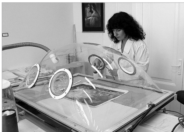
Художник-реставратор I категории Е. Е. Спирина. Реставрация предметов графики на вакуумном столе Фотография М. А. Зиновьевой. 2017
