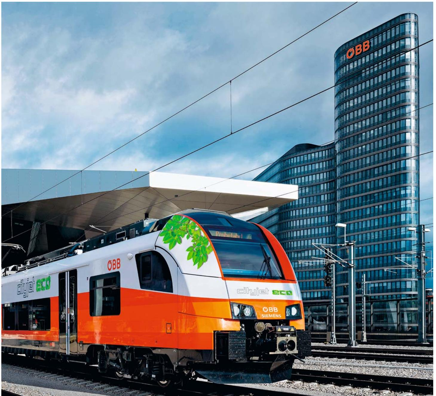
**BATTERIEBETRIEBEN.** Der Cityjet eco wird auch auf nicht elektrifizierten Nebenstrecken mit Strom fahren
