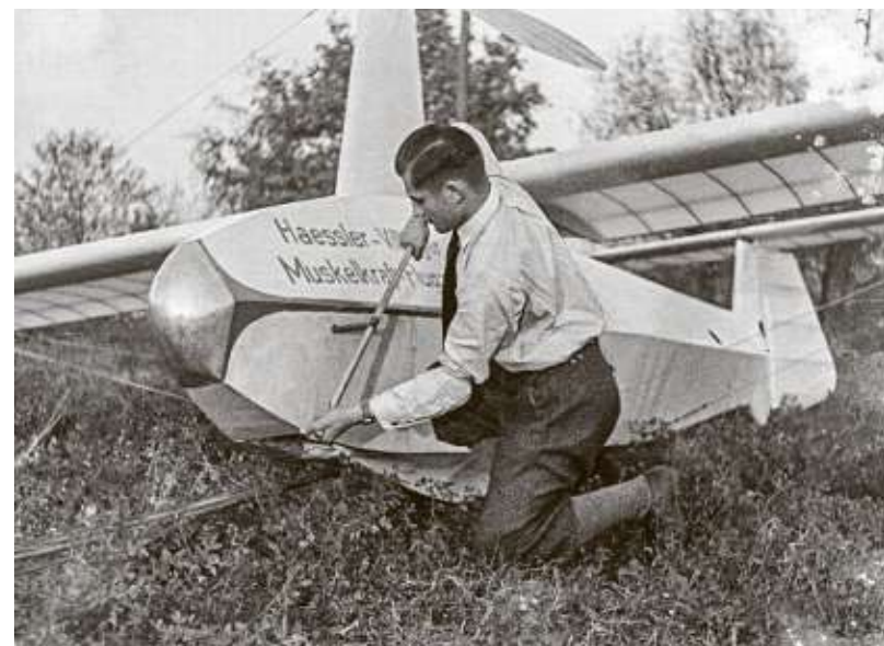
Helmut Haeßler beim Spannen der Gummibandwinde. Die Gummibänder beschleunigen das Flugzeug beim Start.
