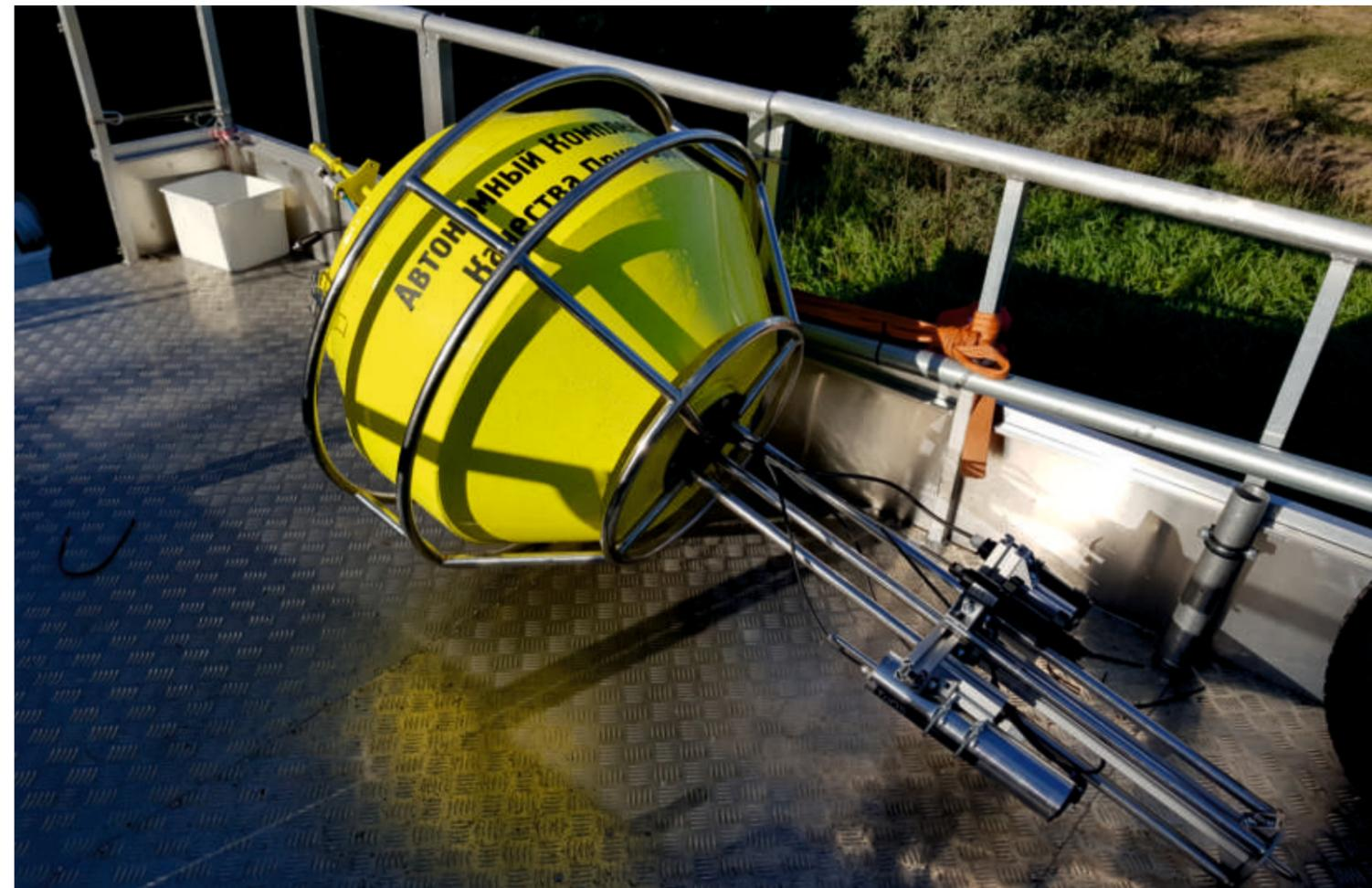
Автономная станция мониторинга качества воды «Буян». Фото: Максим Платонов
