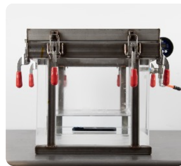
Při testování ochrany proti ponoření do vody IPX7/8 společnost Apple ponoří iPhone do tlakové nádoby, aby simulovala tlak pod vodou.
