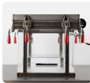
Aby przetestować ochronę przed zanurzeniem w wodzie klasy IPX7/8 Apple zanurza iPhone'a w naczyniu pod ciśnieniem symulującym ciśnienie panujące pod wodą.
