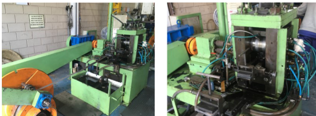
Figura 2. Laminador de seis cilindros utilizado para a deformação a frio do aço SAE 1080.
