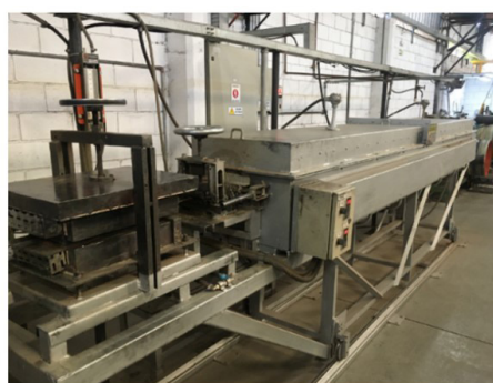
Figura 1. Linha contínua utilizada para realizar o tratamento térmico de patenteamento no aço SAE 1080.
