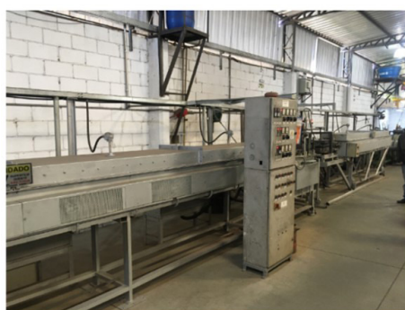
Figura 1. Linha contínua utilizada para realizar o tratamento térmico de patenteamento no aço SAE 1080.
