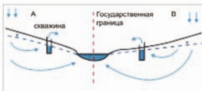
3) Государственная граница проходит по крупной реке или озеру, аллювиальный пласт соединен с рекой, трансграничные потоки подземных вод незначительны.
