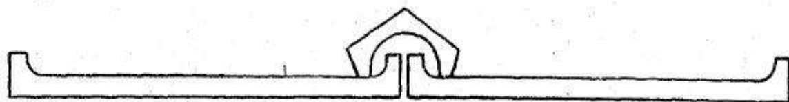
Рис. 62. Перекрытие боковых стыков черепиц калиптерами (разрез).
