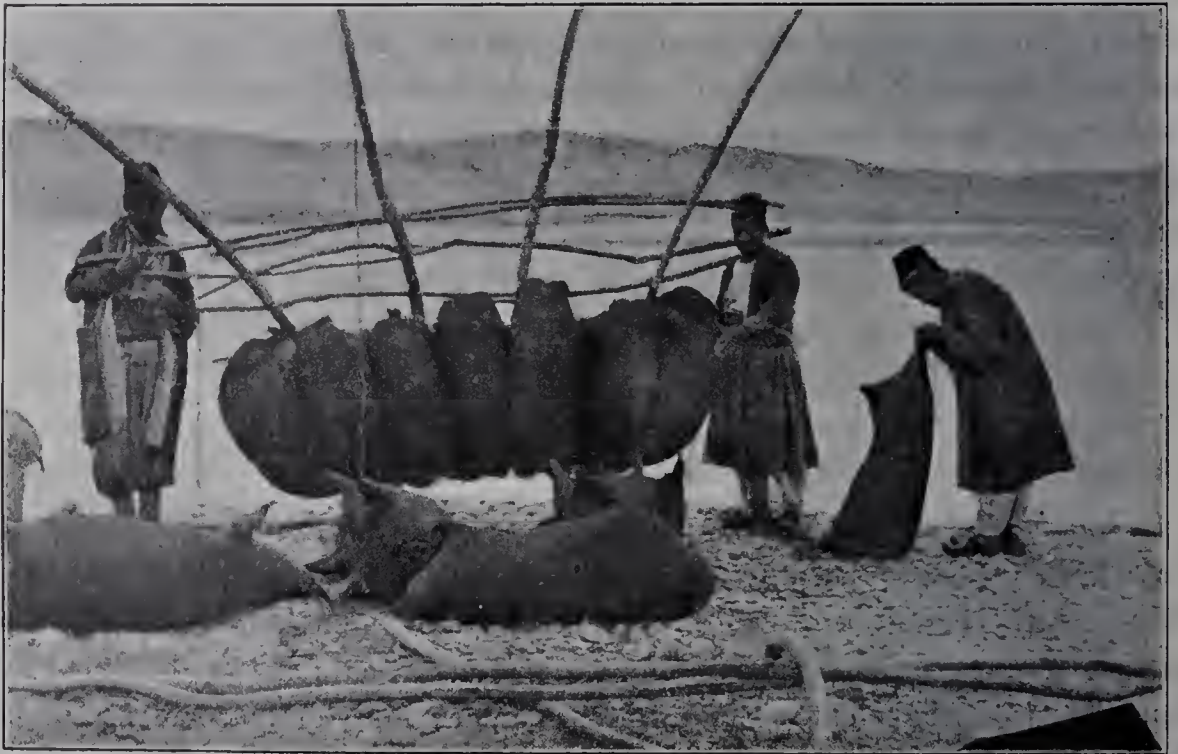
Bau des Kelek.
