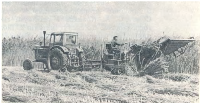
Випробування коноплежатки, сконструйованої у Всесоюзному науково-дослідному інституті луб'яних культур, м. Глухів. 1972 р.
