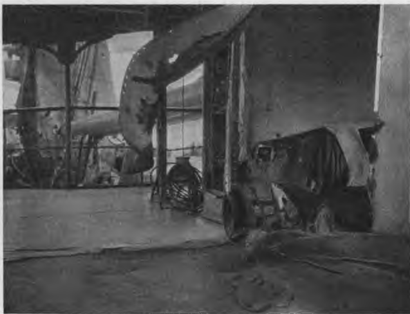
Разрушеніе мостика 12-дюймовымъ снарядомъ.
