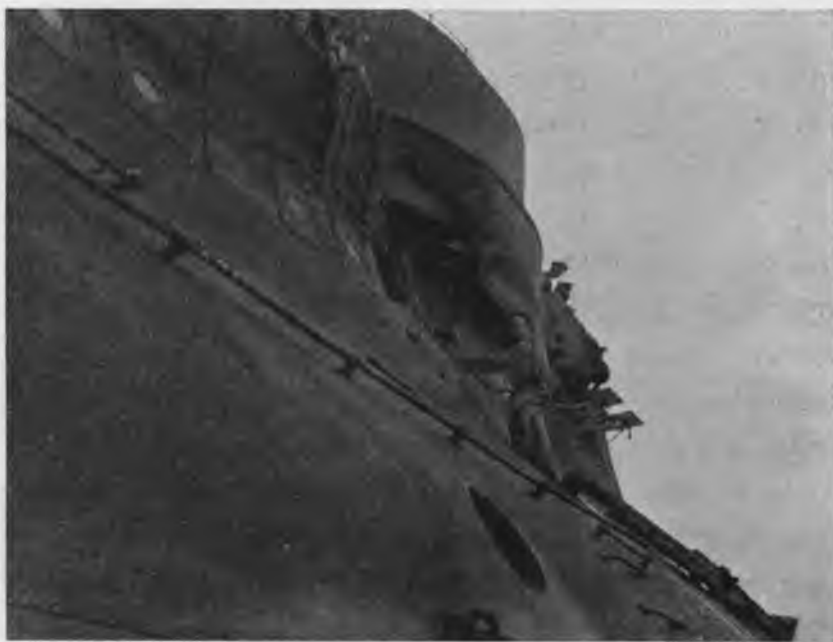
Пробоина подъ правой броневою башней броненосца.
