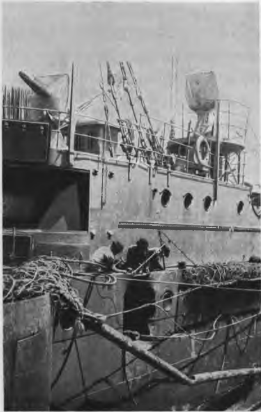
Пробоина 12-дюймовымъ снарядомъ.
