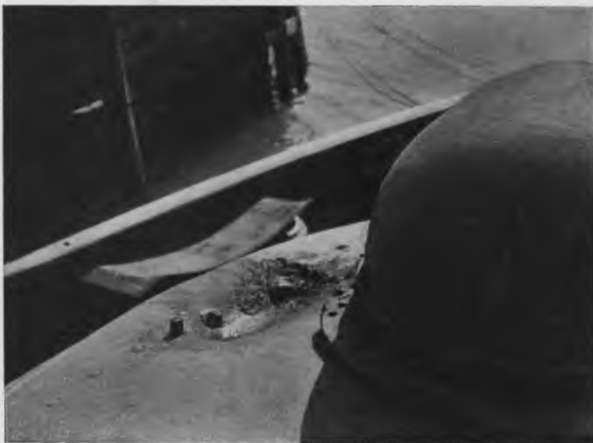
Поврежденія въ носовой башнѣ 12-сант. снарядомъ.
