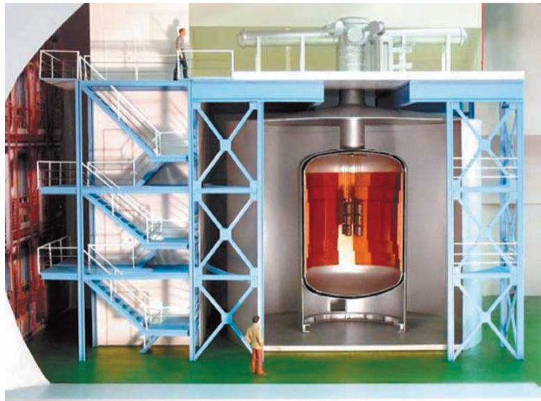
Рис. 1. Схема установки GERDA (с сайта [1])
