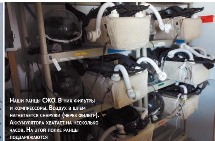
НАШИ РАНЦЫ СЖО. В НИХ ФИЛЬТРЫ И КОМПРЕССОРЫ. ВОЗДУХ В ШЛЕМ НАГНЕТАЕТСЯ СНАРУЖИ (ЧЕРЕЗ ФИЛЬТР). АККУМУЛЯТОРА ХВАТАЕТ НА НЕСКОЛЬКО ЧАСОВ. НА ЭТОЙ ПОЛКЕ РАНЦЫ ПОДЗАРЯЖАЮТСЯ
