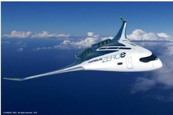
**„Blended-wing body“-Design** (bis zu 200 Passagiere) bei dem die Tragflächen und der Rumpf ineinander übergehen; die Reichweite ist ähnlich wie beim Turbofan-Konzept. Der besonders breite Rumpf bietet verschiedene Optionen für die Wasserstoffspeicherung und -verteilung sowie für unterschiedliche Layouts der Kabine.
