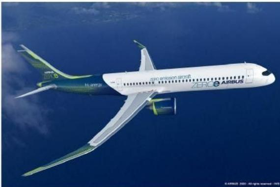
**Turbofan-Design** (120-200 Passagiere) mit einer Reichweite von über 3.700 Kilometern für Interkontinentalflüge und modifiziertem Gasturbinentriebwerk, in dem statt fossilem Treibstoff Wasserstoff verbrannt wird. Der flüssige Wasserstoff wird in Tanks mitgeführt, die sich hinter dem hinteren Druckschott befinden.
