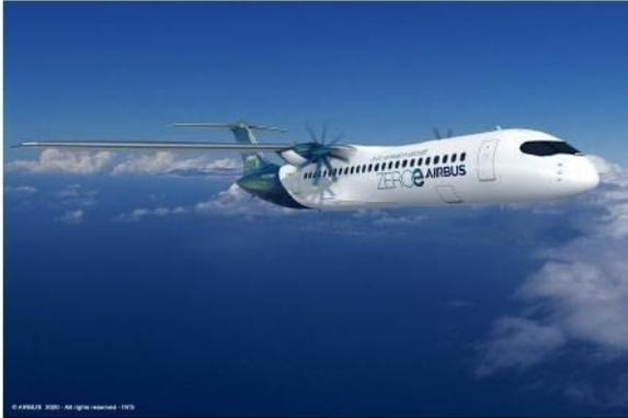
**Turboprop-Design** (bis zu 100 Passagiere) mit Turboprop- statt Turbofan-Triebwerk, ebenfalls auf Basis von Wasserstoffverbrennung in modifizierten Gasturbinentriebwerken, und einer für Kurzstreckenflüge optimalen Reichweite von über 1.850 Kilometern.
