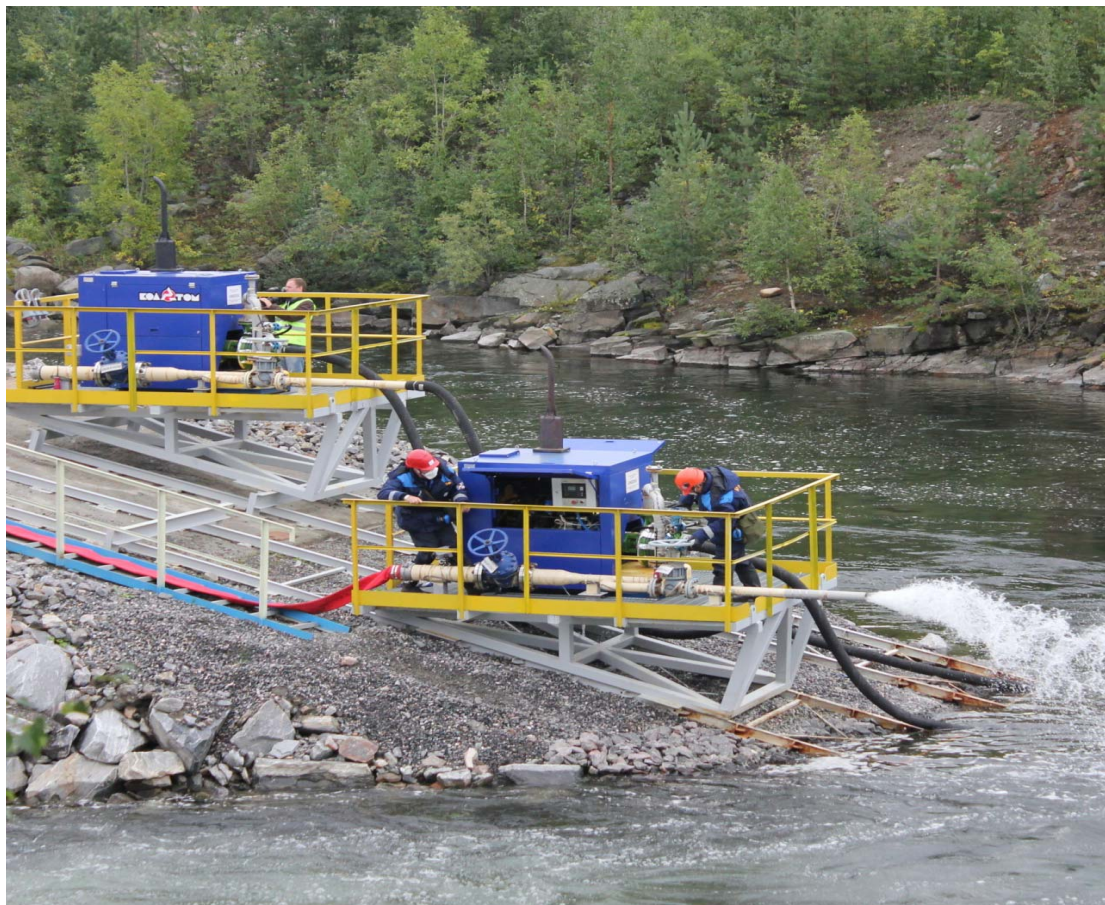
Рисунок 16.7. Комплексные противоаварийные учения на Кольской АЭС (2014 г.). Отработка подключения насосной установки для подачи охлаждающей воды на энергоблоки 1-4 Кольской АЭС
