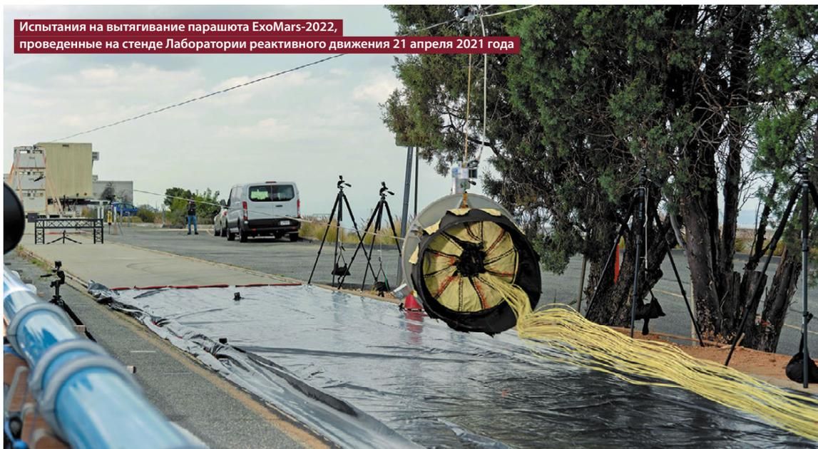
пе они включали проверку запасного сверхзвукового парашюта производства американской фирмы Airborne Systems, а на втором – доработанного дозвукового парашюта и его контейнера производства итальянской компании Arescosmo. В ходе каждого этапа воспроизводились расчетные нагрузки, которые будут действовать во время входа в атмосферу Марса, снижения и посадки. Учитывались запасы на нештатные ситуации.
