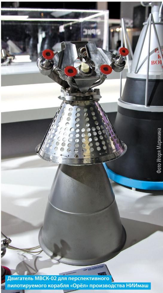
Двигатель MBCK-02 для перспективного пилотируемого корабля «Орёл» производства НИИмаш
