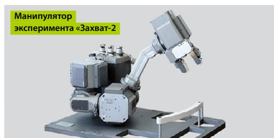
работать захват манипулятором имитаторов поручней с определенной силой сжатия, проверить исправность электроприводов и изучить свойства материалов в условиях открытого космоса.
