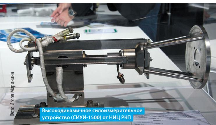
Высокоскоростное силоизмерительное устройство (СИУИ-1500) от НИЦ РКП
