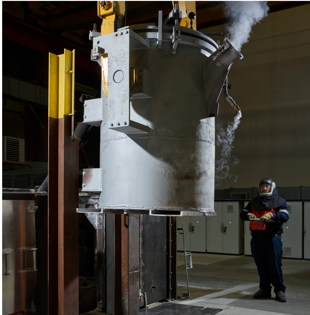
Le procédé innovant de fusion directe sans émission de carbone d'ELYSIS a le potentiel de réduire l'impact climatique du processus de production de l'aluminium, l'un des métaux les plus utilisés au monde.
