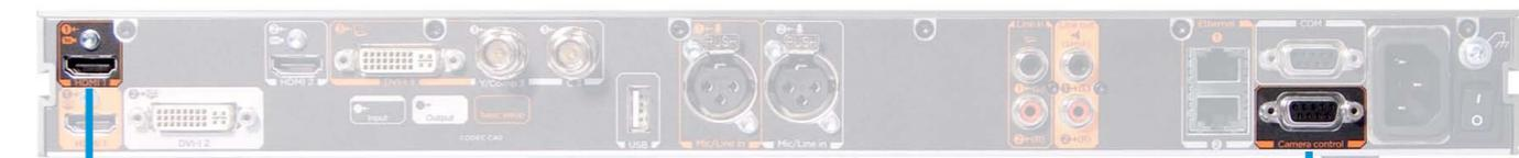
Connectez la **sortie vidéo HDMI** de la caméra à l'entrée **caméra principale HDMI** du codec.
