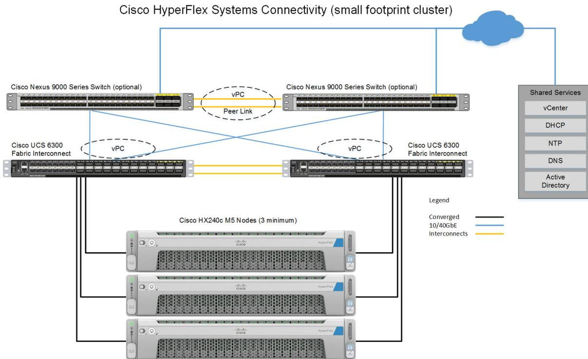
図 6 ファブリック インターコネクト展開モードなしで HX240c M5 ノード データ センタを使用したスモール フットプリント クラスタ
