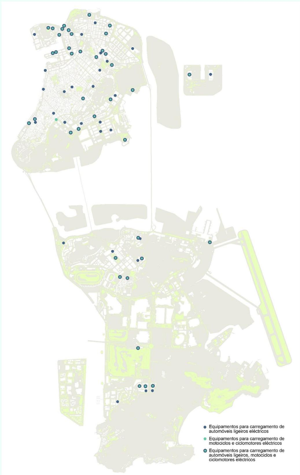
**Figura 9 Diagrama de distribuição dos equipamentos de carregamento de electricidade públicos para veículos eléctricos em Macau<sup>4</sup>**
