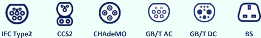
**Figura 10 Padrões de carregamento de electricidade para veículos eléctricos**
