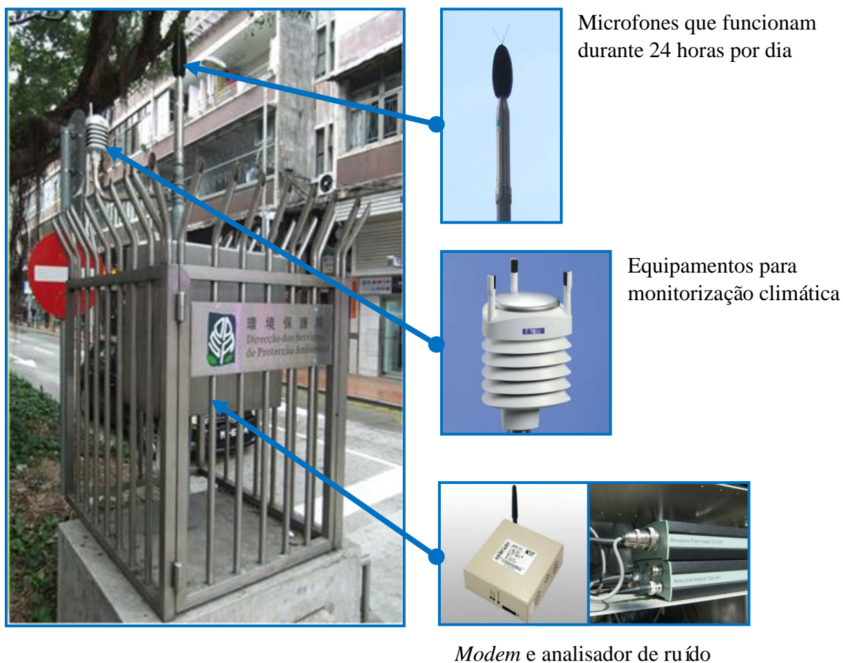
Figura 2.1 Aparelhos existentes nas estações de monitorização de ruído ambiental
