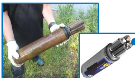
Equipamentos de monitorização automática multi-parâmetros da qualidade da água
