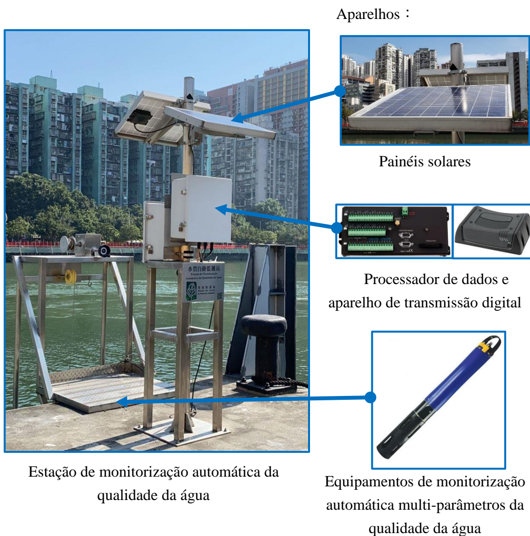
Figura 2.1 Aparelhos das estações de monitorização automática da qualidade da água
