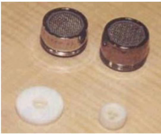
(Foto 5.2) Controladores do fluxo de água nas torneiras permitem uma redução no consumo de água.
