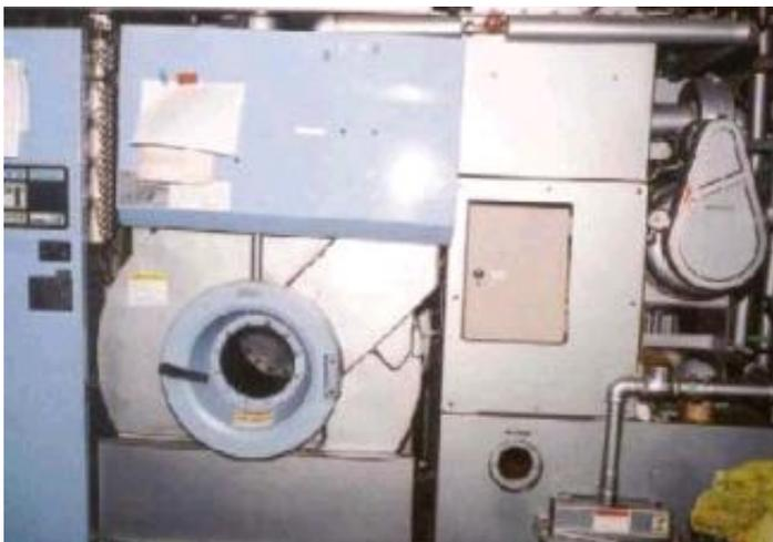
(Foto 4.12) Uma máquina de lavar a seco com um sistema de recuperação de vapor controla as emissões prejudiciais.
