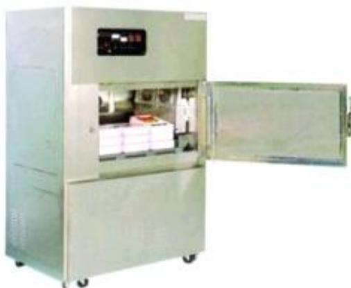
(Foto 5.11) O método de descongelamento por ondas de alta frequência aquece os alimentos uniformemente, eliminando, desta forma, a utilização de água.
