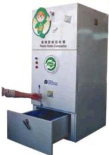
(Foto 6.10) Um compactador de latas de alumínio e de garrafas de plástico reduz o volume das mesmas, significativamente, e consequentemente, o custo do transporte destes resíduos
