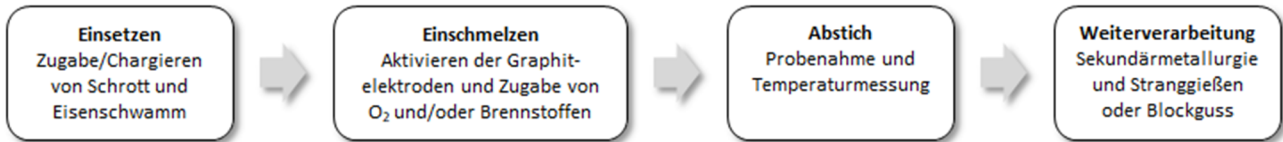
Abbildung 19: Übersicht der Prozessschritte zur Elektrostahlherstellung (Quelle: Eigene Darstellung in Anlehnung an (Ausfelder, et al., 2018))
