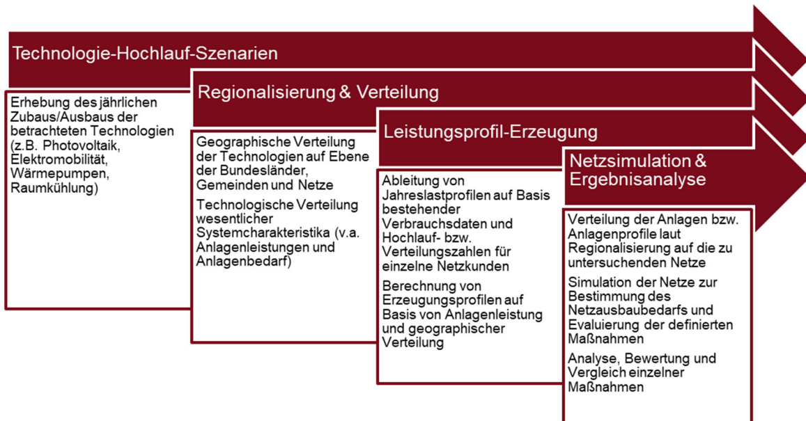
Abbildung 78: Darstellung der grundsätzlichen, methodischen Vorgehensweise für die Erstellung einer quantitativen Basis für die Entwicklung von strategischen Netzentwicklungsplänen
