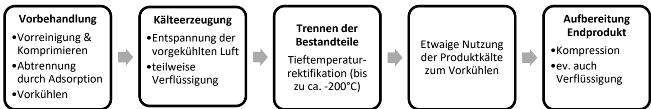
Abbildung 17: Übersicht der Teilprozesse der Luftzerlegung
