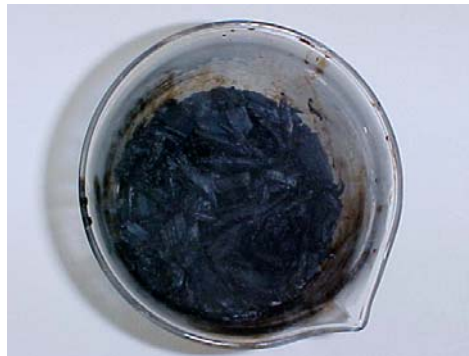
Cozimento kraft de casca de eucalipto (Número kappa polpa ~60; Alvura ~15%ISO; Álcali Ativo = 27%)
