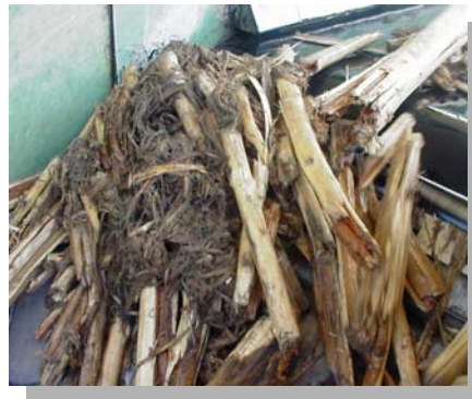
Perdas de madeira e fitas de cascas acompanhando toras ao picador
