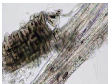
Shive de fibras de floema e grumo de esclereídeos
