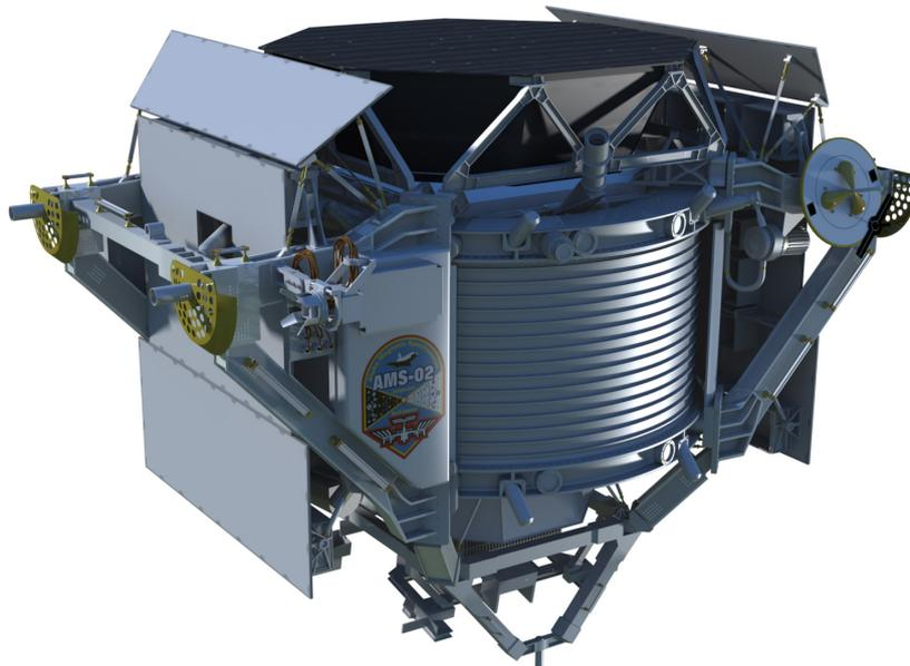
Figura 2.1: *Disegno CAD del rivelatore AMS-02 completo della struttura di supporto per l'installazione sulla ISS.*
