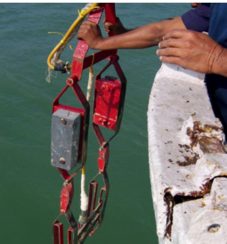
放射性示踪剂用于监测海洋中的沉积物输运。 (图/巴巴原子研究中心)
