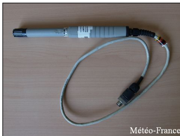
Photo 3 : Sonde capacitive d'humidité © Météo-France
