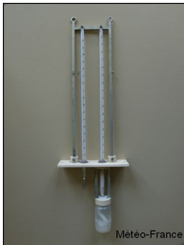
Photos 1 et 2 : Psychromètre fixe et psychromètre à crécelle © Météo-France
