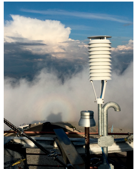
Figure 10. L'abri météo hébergeant la sonde de température de la station du mont Ventoux, 27/09/2015.
