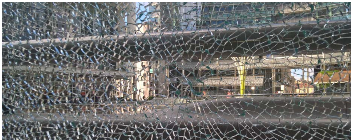
FIGURA 4. ROTTURA DI UNA LASTRA STRATIFICATA DI SICUREZZA
