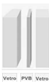
FIGURA 3. LASTRA STRATIFICATA DI SICUREZZA
