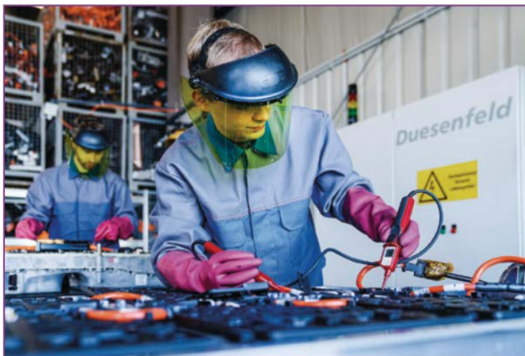
Abbildung 8: Entladestation der Fa. Duesenfeld GmbH (Elwert und Frank 2020).
