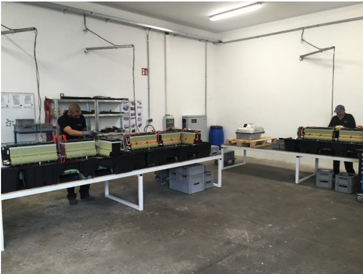
Abbildung 7: Entlade- und Demontagestation der Fa. Redux GmbH (Arnberger et al. 2018).
