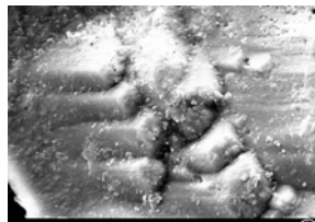
3. att. “Dakstiņa tipa” reģenerācijas formas uz almandīna grauda virsmas (paraugs M5 D 3 g).
